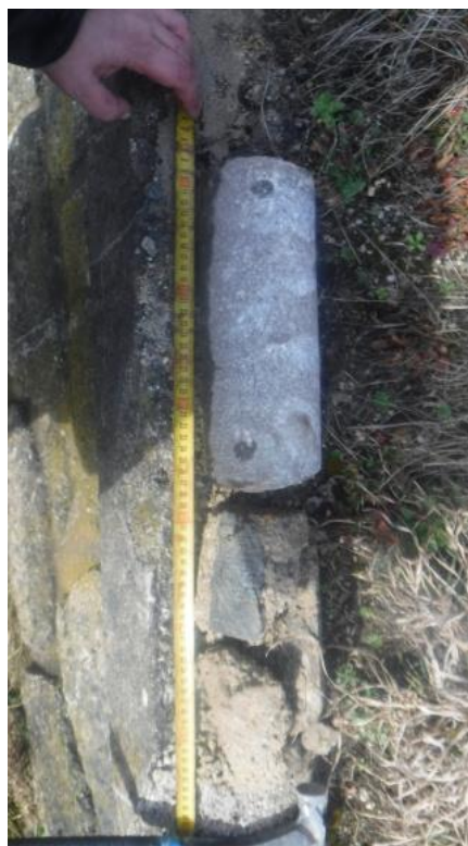
Obr. 3 Malta za kamenným zdivem
